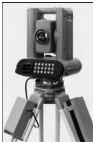
Der registrierende elektronische Reduktionstachymeter Wild Tachymat TC1: 1978 übernahm die Elektronik auch das Messen der Winkel und das Protokollieren der Messwerte.
