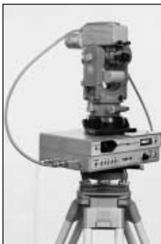
Als Bestseller erwies sich 1973 der IR-Distanzmesser DISTOMAT DI3. Nach Eingabe des Vertikalwinkels zeigt er sofort die Horizontaldistanz und den Höhenunterschied an.
